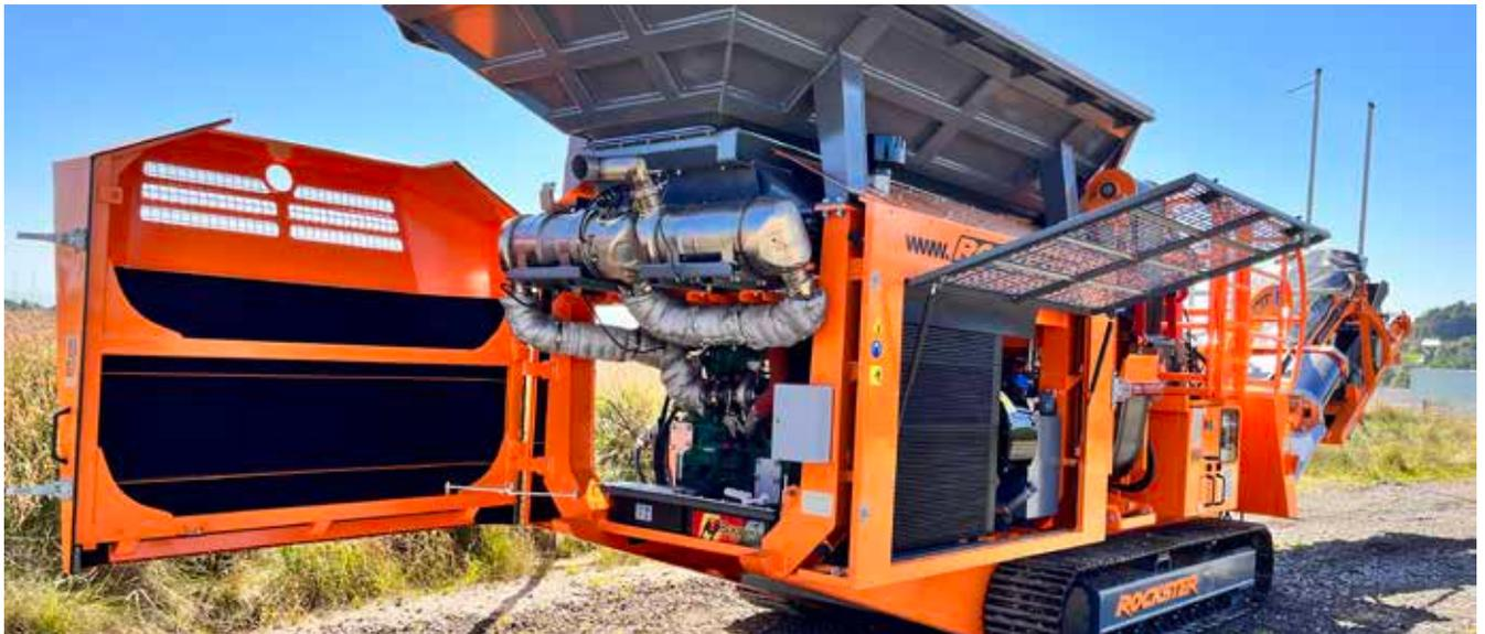
Die großflächigen Öffnungen erlauben eine optimale Zugänglichkeit für sämtliche Service- und Wartungsarbeiten und ermöglichen zusätzlich eine optimale Belüftung des Motorpaketes und der Kühlung.
