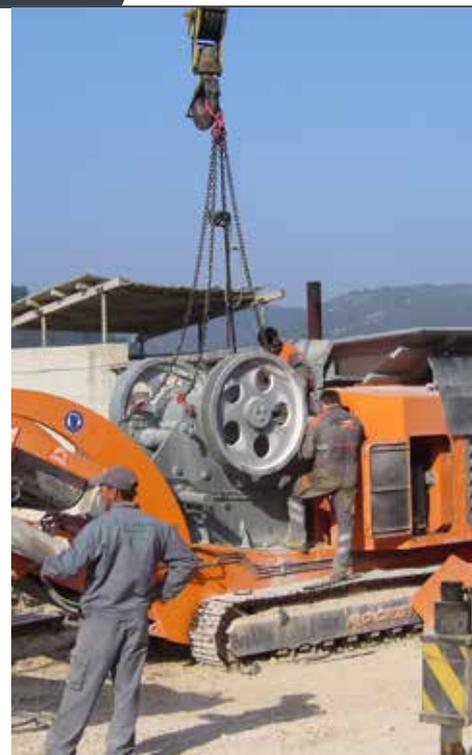
In kürzester Zeit kann die Rockster raupenmobile Brechanlage R900 von Prallbrecher auf Backenbrecher R800 umgerüstet werden – und vice versa. Das Original Duplex-System ermöglicht schnelle und effiziente Abstimmung auf
