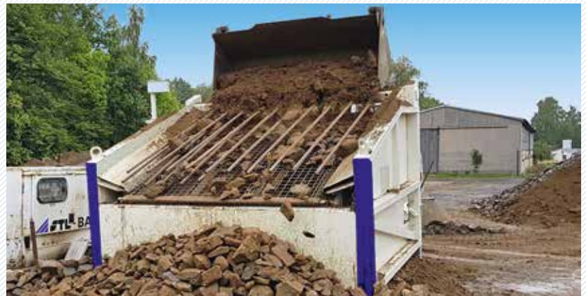
NÜTZLICHE ERGÄNZUNG: Im Bemühen, Gesteinsanteile von feinkörnigem Gut zu trennen, machen die Siebeinheiten eine hervorragende Figur. Foto: BHS Innovationen
