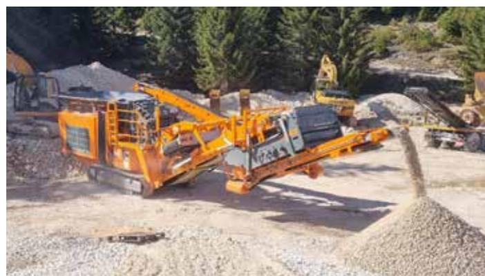
**„Der Transport zur Baustelle über die Serpentina der Passstraße ist aufgrund der kompakten Transportabmessungen und des geringen Gewichtes völlig problemlos. Wir können den Brecher in kürzester Zeit auf- und entladen und sind in wenigen Minuten einsatzbereit.“**
