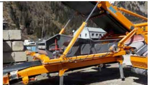
Siebkasten hydraulisch absenkbar!
