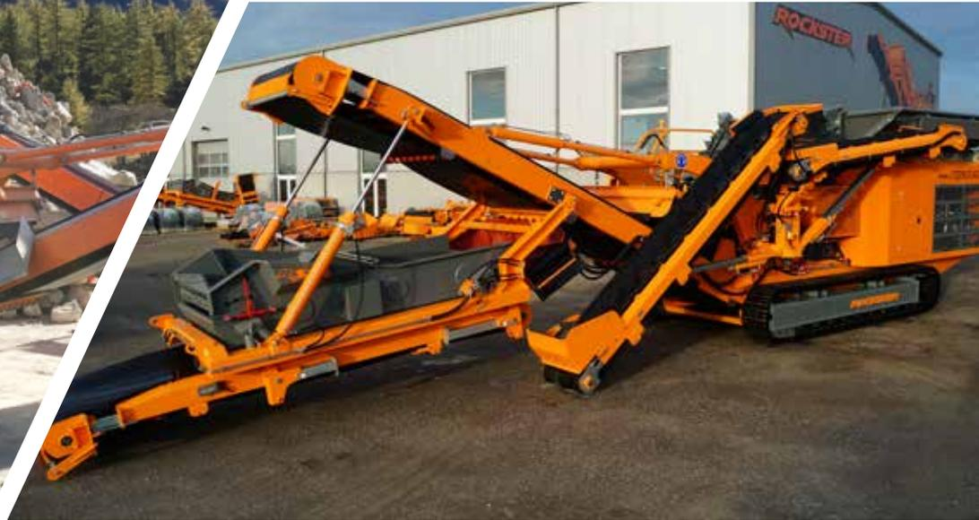
Das optionale Siebssystem besteht aus dem kompakten Kreisschwingsieb und dem rechtlich geschützten Rückführ-/ Haldenband. Dieses Siebssystem ermöglicht einen geschlossenen Brechkreislauf und bildet somit die perfekte
